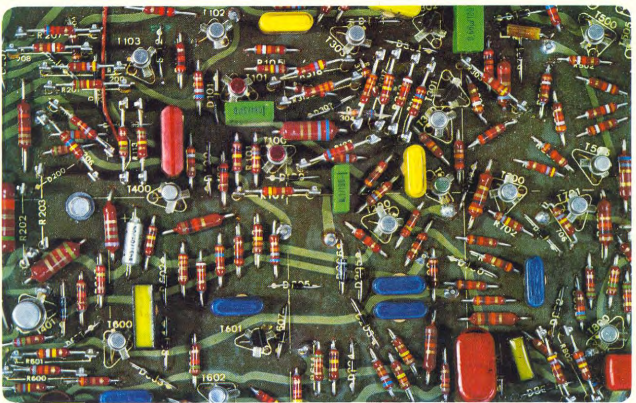
"Hjärnan" i systemet är detta elektroniska styrdon. Den är uppbyggd som ett kretskort och innehåller cirka 250 komponenter varav cirka 30 är transistorer och cirka 40 är dioder.
