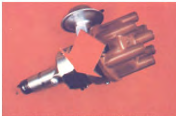
Bild 17. Tändfördelaren (pilen visar impuls-kontakternas placering).
