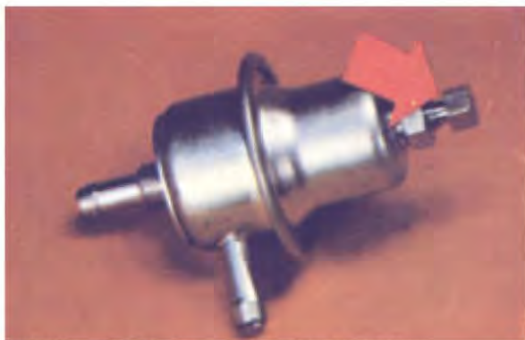
Bild 39. Justerskruv på tryckregulatorn.
