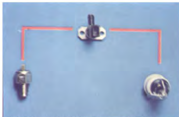
Bild 31. Elektrisk förbindning starttändlås - termo-kontakt - kallstartsventil.
