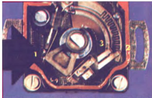
Bild 38. Luftspjällskontakten öppnad. Pilen visar på kontaktparet för bränsleavstängning. Till höger släpkontakter och kontaktbanor.
