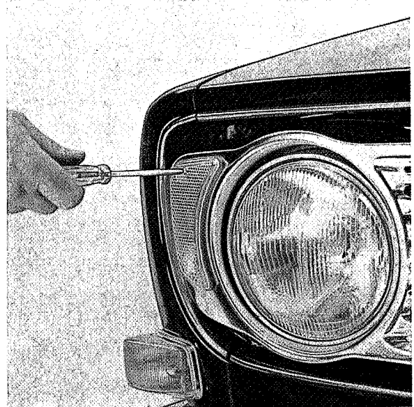
Fig. 3-80. Stadslicht, demontage van het glas
