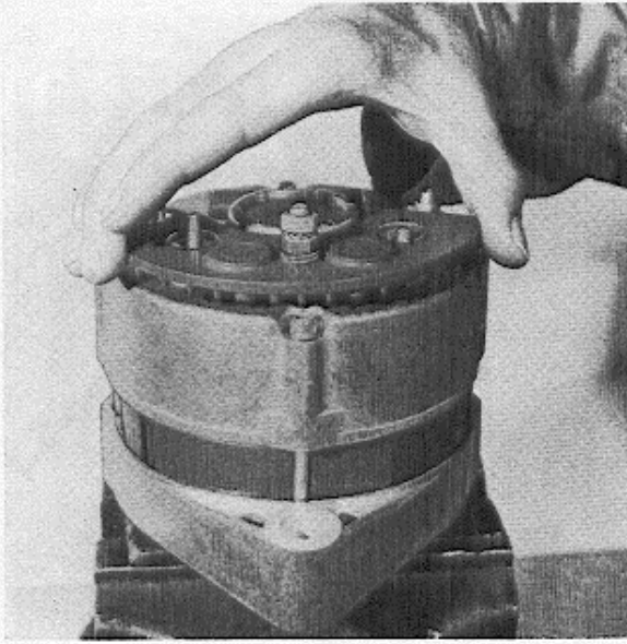
Abb. 3—5 Einbau der Erregerdioden
