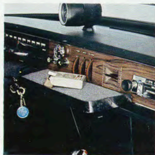
Konsole mit Kippschalter und Ausparung für Heizuhr oder elektrische Uhr 281374
