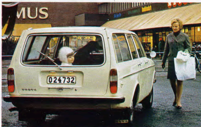
Scheibenwischer und -spüler für die Heckscheibe des Volvo 145 277978
