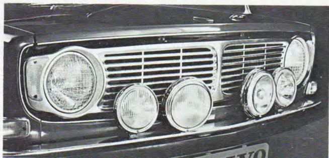
Zusatzscheinwerfer Breit- und Weitstrahler in verschiedenen Ausführungen
