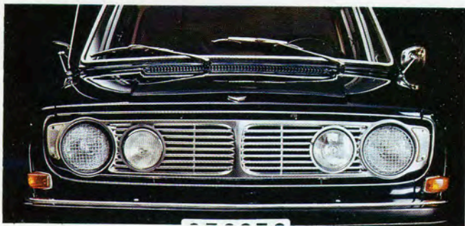
Kühlergrill, komplett mit Zusatzscheinwerfer 281035
