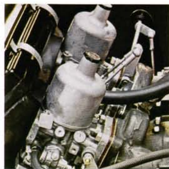
Le moteur à deux carburateurs de 118 ch SAE assure un surcroît de puissance et de nervosité.
