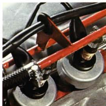
Le B 20 E — un moteur à injection électronique de 130 ch SAE, d'une puissance encore plus élevée.
