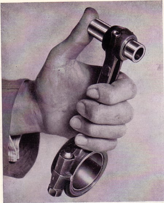
Fig. 36 Gudgeon pin fit
