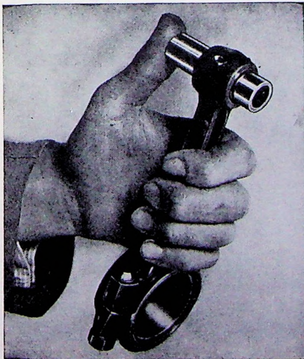
Fig. 36. Gudgeon pin fit
