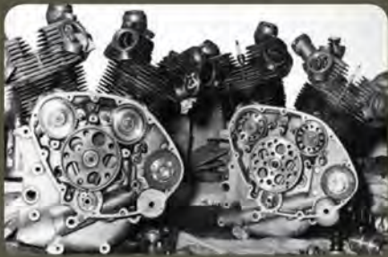
Tandwieltrain met hoogliggende nokkenassen
