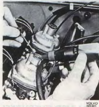
Bild 13. Kontroll av oljenivå i centrumspindel
