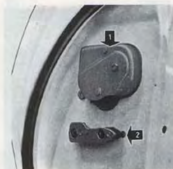
Bild 56. Dörrlås 1. Smörjhål (tunn olja) 2. Dörrnäsa (paraffin)
