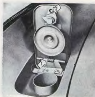
Bild 52. Tanklock, 1800 1. Gångjärn (tunn olja) 2. Låsanordning (låsolja)
