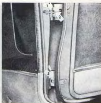
Bild 55. Dörrgångjärn 1 och 2. Gångjärn (tunn olja) 2. Dörrstopp (paraffin)
