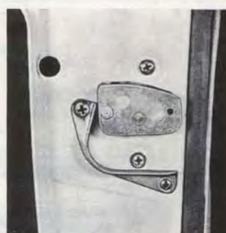
Bild 48. Dörrlås med styrskena
