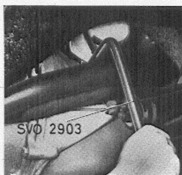
Abb. 24 Ausbau des Ölfilters
