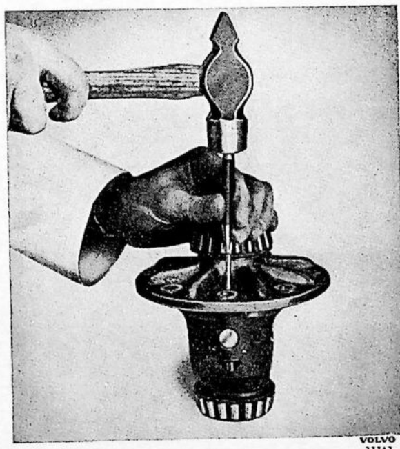
Fig. 4-99. Het verwijderen van de borgpen
