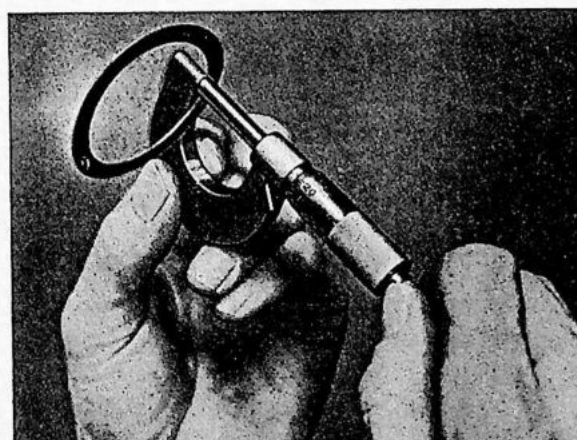
Fig. 4-110. Het meten van de shims
