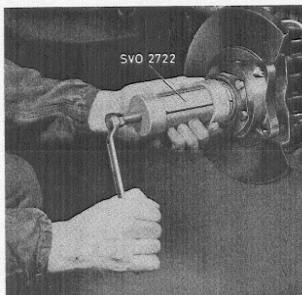
Abb. 25. Ausbau des inneren Vorderradlagers
