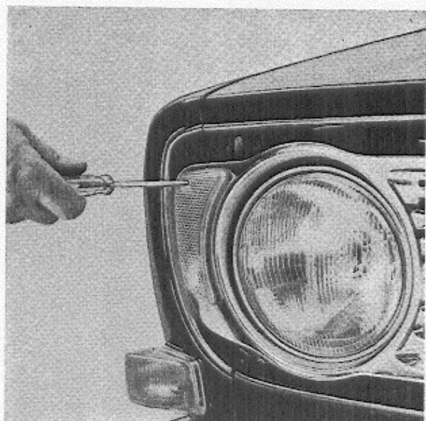
Abb. 117 Standleuchte, Ausbau des Glases
