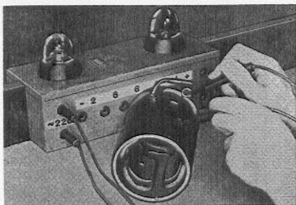
Fig. 3-46. Het controleren van de veldwikklingen
