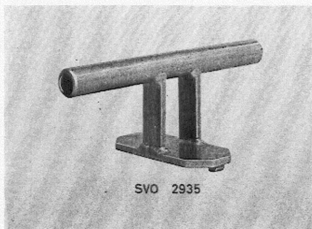
Abb. 3-22 Spezialwerkzeug zum Ausbau des Kraftstoff-Vorratsgebers
