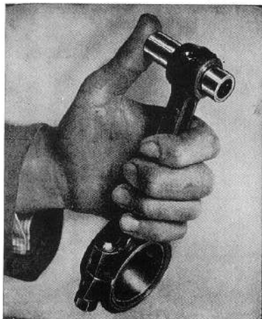
Fig. 36. Gudgeon pin fit
