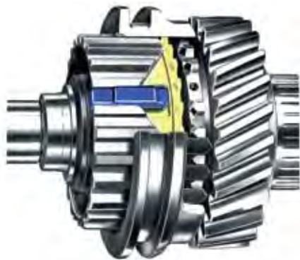
1 hoofdas 2 synchroniseertrommel 3 blokkeerspie 4 schakelring 5 synchromeshring 6 tandwiel
