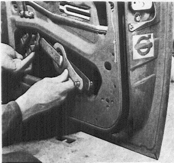
Abb. 30 Fensterheber mit Kurbelmechanismus
