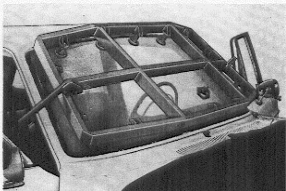
Abb. 50 Einbau der geleimten Frontscheibe mit Hilfe des Preßrahmens 2899
