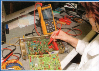
Bei der Fehlersuche an der D-Jetronic reichen oft noch ganz simple Mehrfachmessgeräte
