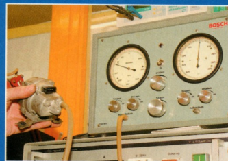
Funktioniert das wichtigste Regelement? Auch für den Druckfühler gibt es ein Bosch-Messgerät
