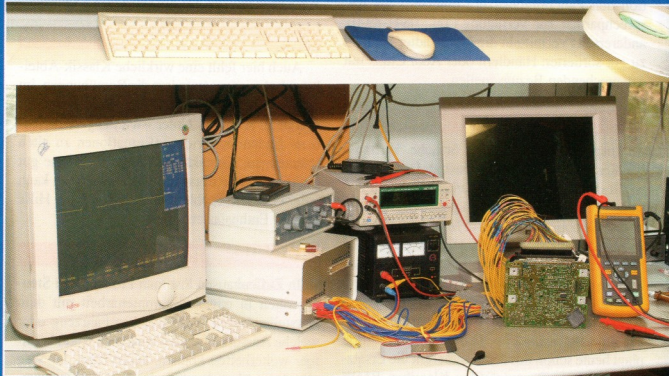
Digitalisierte Motronic-Anlagen lassen sich nur mit Computer-Messtechnik prüfen. Hier geht es nicht nur um die technische Ausstattung, auch die Solldaten der jeweiligen Anlage müssen bekannt sein
