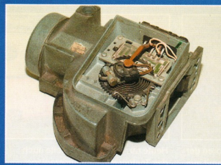
Der Luftmengenmesser der L-Jetronic gibt seine Messergebnisse über ein Potentiometer weiter
