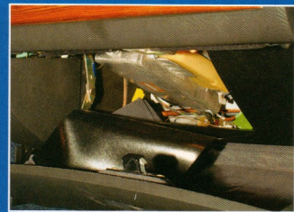
Gut versteckt: Das kompakte Steuergerät liegt über dem Handschuhfach des großen BMW
