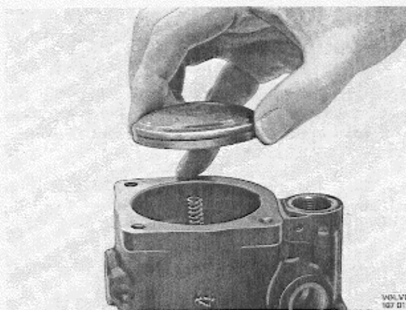
Abb. 133 Einbau des Pumpdeckels
