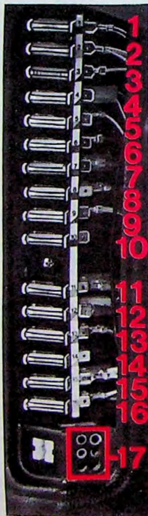
17 Gaten voor reservezekeringen
