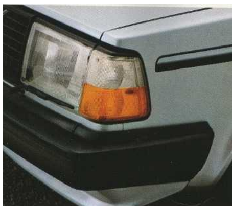
3. Nya lättare stötfångare, som går mer "runt hornen", reducerar totallängden på bilen.
