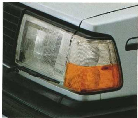
2. Nytt ljusarrangemang med inbyggda korriktions-, varsel- och parkeringsljus.
