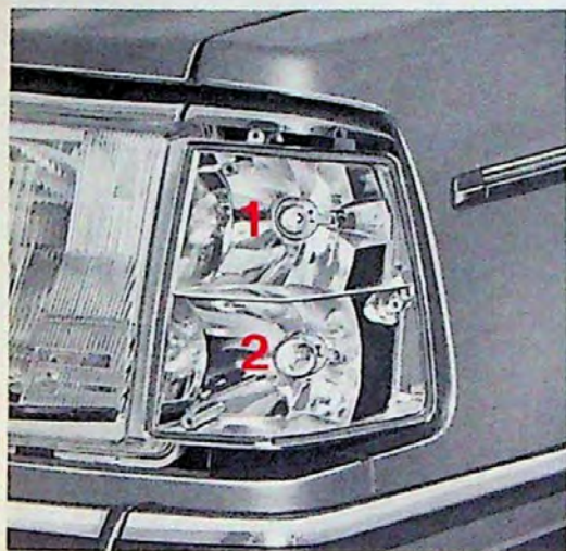
Plaats van de lampen
