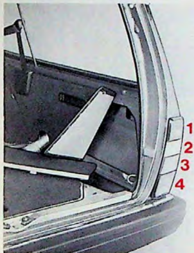
Plaats van de lampen
