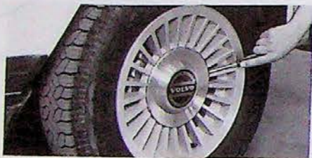
Wieldop met schroevendraaier verwijderen
