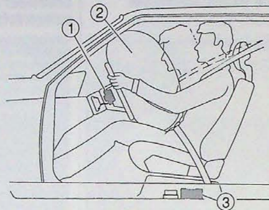
Onderdelen van het SRS-systeem
