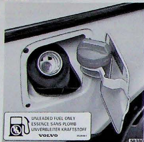
Vulpijp met vernauwing bij auto's met katalysator
