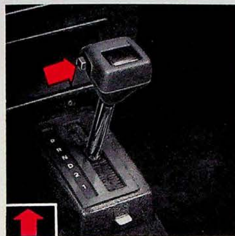
Schakelaar en controlelampje voor het uit-/inschakelen van de 4e versnelling
