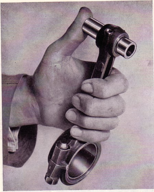
Fig. 36 Gudgeon pin fit
