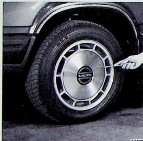
Wieldop verwijderen met schroevendraaier
