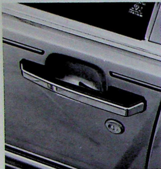
De centrale vergrendeling wordt vanaf het bestuurdersportier bediend.
