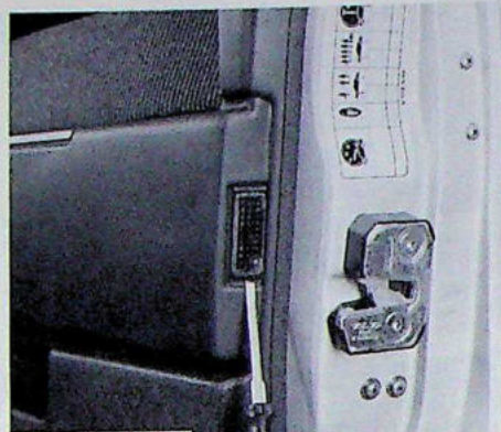
5 W W 2,1 x 9,5 d Steek de schroevendraaier in en draai deze voorzichtig
