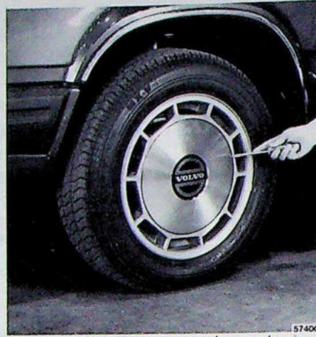
Wieldop verwijderen met schroevendraaier
