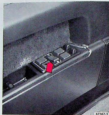
Schakelaar, raammechanismen achter
