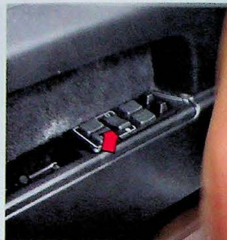
Schakelaar, raammechanismen achter
