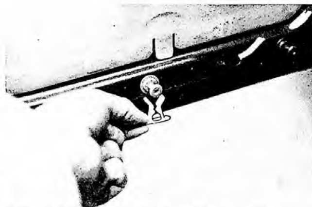
Figuur 6.16: Onder de kaartenbak zijn vanaf de onderzijde drie borgclips bereikbaar, waarmee het bekledingspaneel op zijn plaats gehouden wordt (op de afbeelding is de kaartenbak verwijderd)
