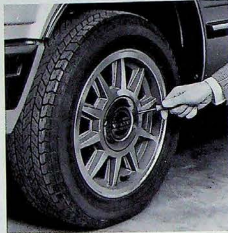
Wieldop verwijderen met schroevendraaier
