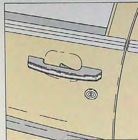
De centrale vergrendeling wordt vanaf het bestuurdersportier bediend.
