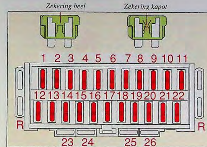
Nummering van de zekeringen in het zekeringenkastje.
