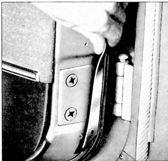
Fig. 15.7. Deurrubber over deurscharnier
