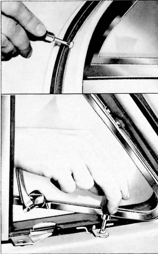
Fig. 15.20. Losmaken van het ventilatieraampje
