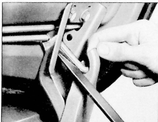
Fig. 15.3. Verwijderen van de voorspanning van de torsieveren van de achterklep.
