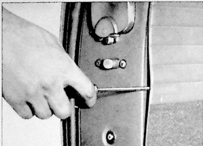
Fig. 15.11. Verwijderen van de bekleding
