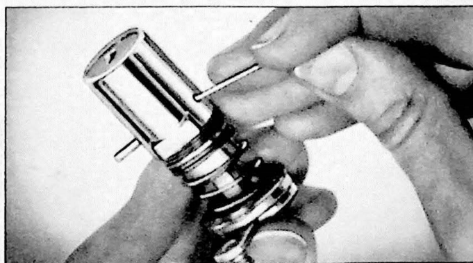
Fig. 15.15. Verwijderen borgpen van het deurslot
