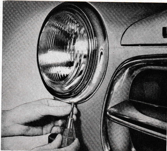
Fig. 65. Removing the headlight rim.
