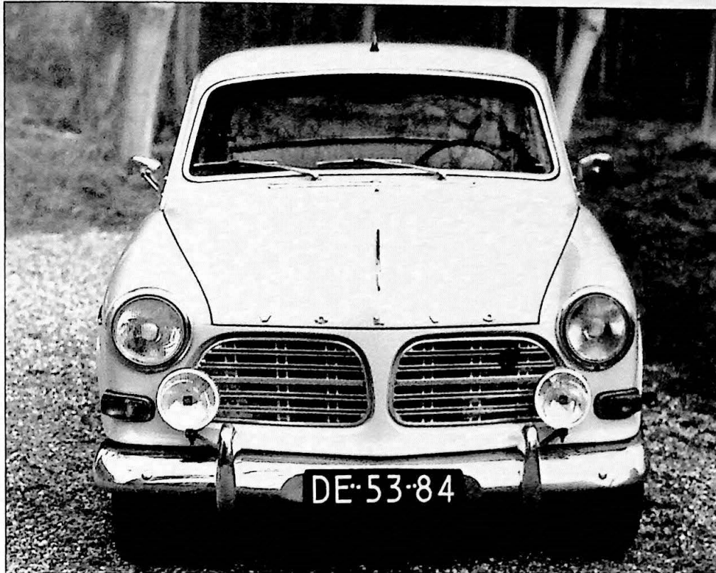
Amazon P130 (121) 1968, grill (laatste type) met Volvo embleem, neusstrip, ruitensproeier op motorkap.
