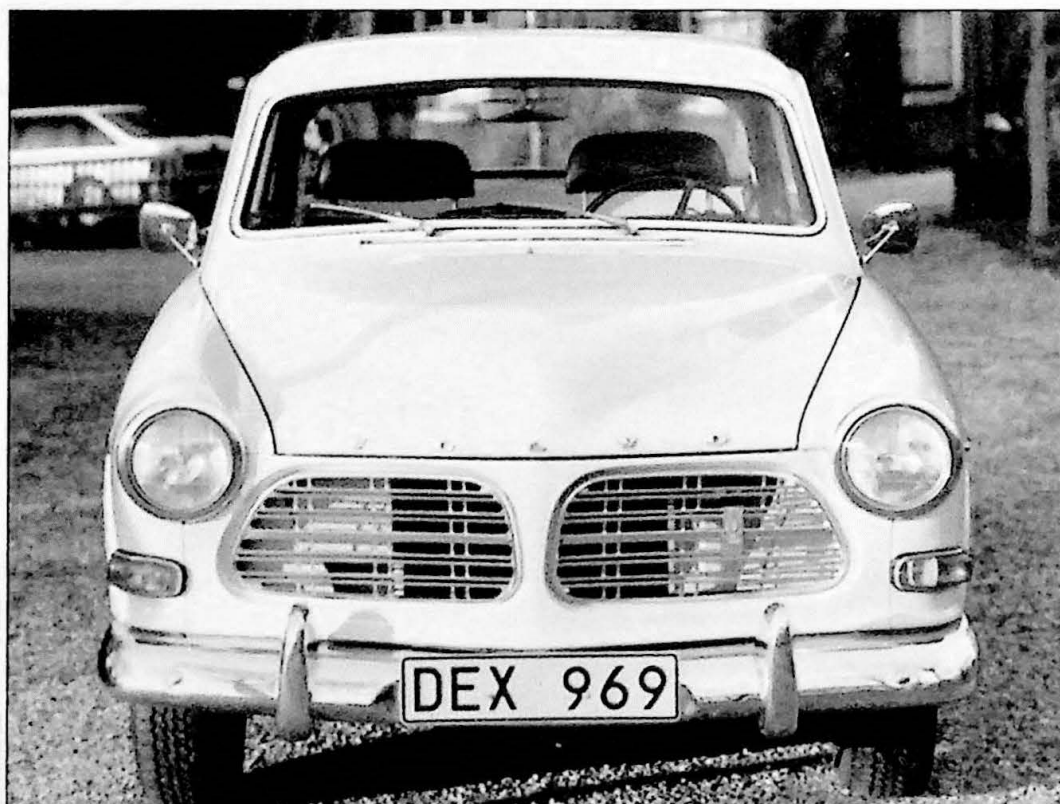
Amazon P130 1970, laatste type grille met "B20"-embleem, gecombineerde richtingaanwijzer/stadslichtunit, geen neusstrip, ruitensproeier zonder uitsteeksels op motorkap, interieur met hoofdsteunen, geen chroom daklijst
