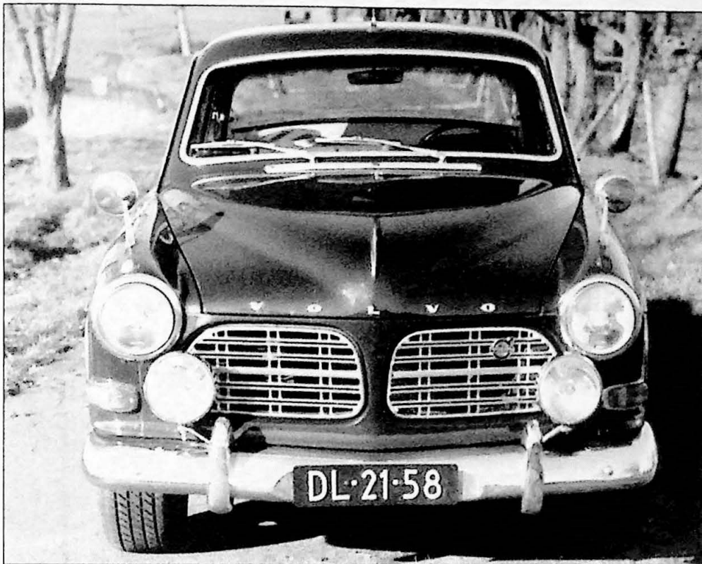
Amazon P130 (123GT) 1967, laatste type grille met "Volvo"-embleem, gecombineerde richtingaanwijzer/stadslichtunit, neusstrip, ruitensproeier op motorkap, spiegels als GT-accessoire, mistlampen als GT-accessoire
