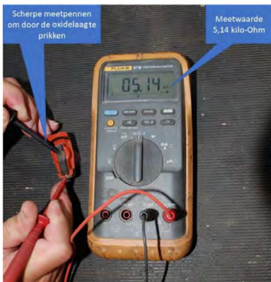
Foto 16 Testen van de rotor
