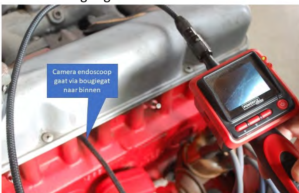
Foto 9 Inspectie met endoscoop
