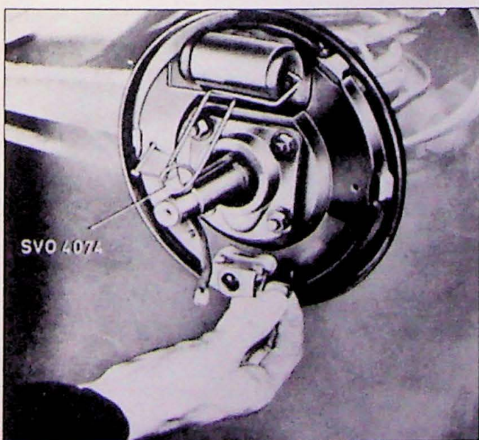
Fig. 11.9. Demontage van de stelnokken
