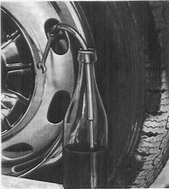
Abb. 72 Mechanische Entlüftung VOLVO 103266
