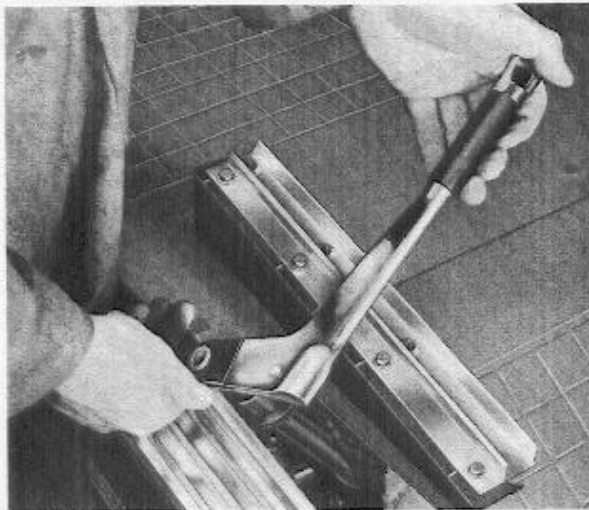
Abb. 113 Ausbau des Handbremshebels, 120
