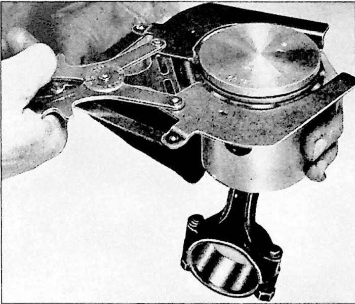
Fig. 2.30. Montage van de zuigerveren
