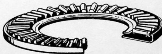
Fig. 4. Axiale naaldlager en drukring, nieuwe uitvoering.
