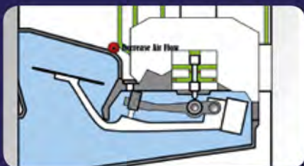
Doorsnee mengselregeling K-jetronic
