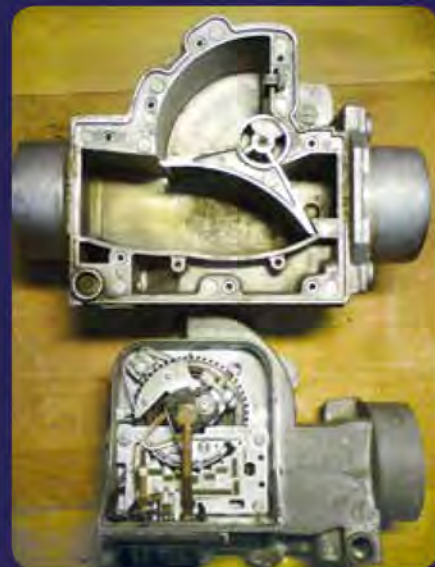
Luchthoeveelheidsmeter L-Jetronic (lucht- en aansluitzijde)
