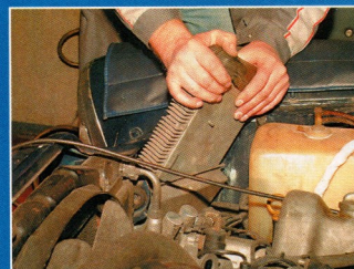
Beim Mercedes sitzt das Steuergerät rechts neben dem Kühler – vorsichtig ausbauen!
