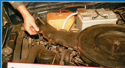
Weil der Luftfilter für die Messungen entfernt werden muss, baut der Techniker zunächst den Thermofühler für die Ansaugluft aus
