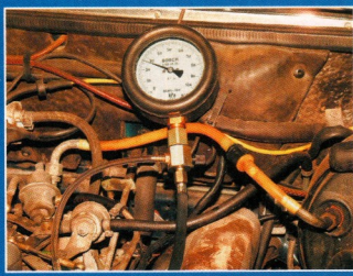
Bei laufender Benzinpumpe sollte der Druck bei zwei bis 2,2 bar liegen. Hier ist er zu hoch
