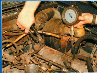
Wird die Rücklaufleitung blockiert, muss der Druck ansteigen – sonst ist sie verstopft
