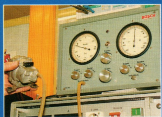
Ein spezielles Vakuumtestgerät überprüft die Funktion der Unterdruckdosens im Alugehäuse
