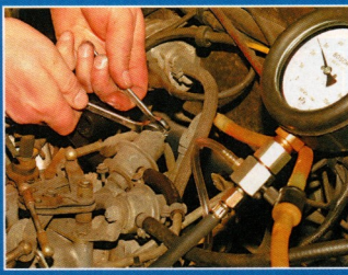
So wird am Druckregler der vorgeschriebene Systemdruck eingestellt
