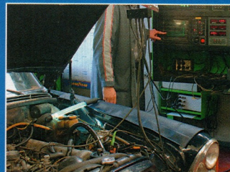
Zunächst werden die übrigen Werte des Motors geprüft: Zündung, Ventilspiel, Kompression...
