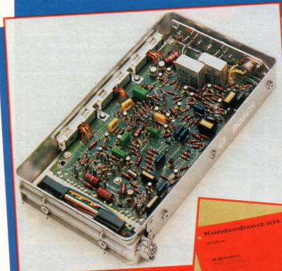
Die schweren Bauteile ließen die Platine schwingen – und brechen
