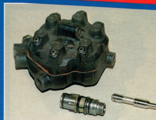
Vorsicht, Standschäden: Der Steuerkolben ist gegen Korrosion äußerst empfindlich
