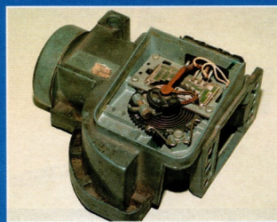
Dumm-Tuning: Oft wird das Potentiometer am Luftmengenmesser in Richtung Last verstellt.
