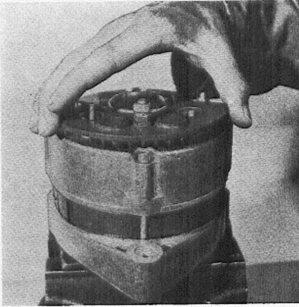
Abb. 3-5 Einbau der Erregerdioden (Schutzdioden)
