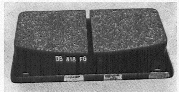
Abb. 5–2 Erkennung der Bremsklötze
