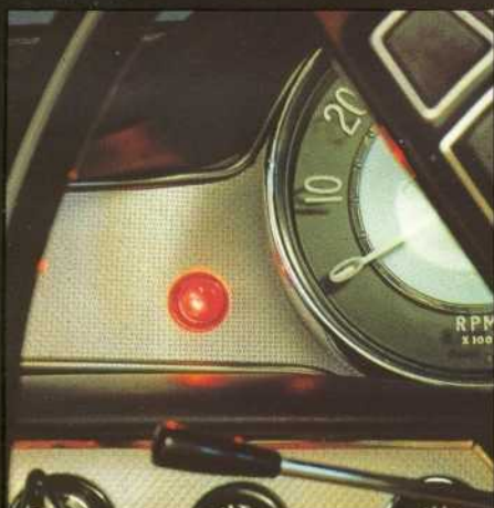
Eine Warnleuchte auf der Instrumententafel zeigt an, wenn die Handbremse noch angezogen oder ein Bremskreis außer Funktion ist
