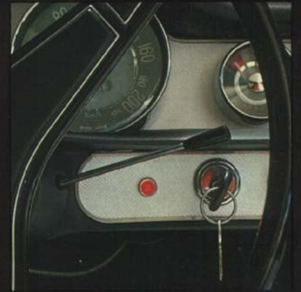
Volvo 1800 S har kopplingsfri överväxel för smidigare, tystare och mer ekonomisk körning.
