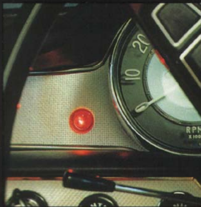
En varningslampa på instrumentbrädan lyser för lödragen parkeringsbroms eller ev. bromskretsfel.
