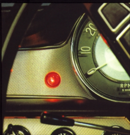
En varningslampa på instrumentbrädan lyser för åtdragen parkeringsbroms eller ev. bromskretsfel.
