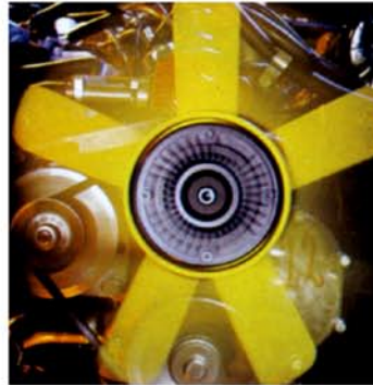
Antrieb des Lüfters über eine Viscose-Kupplung: Seine Drehzahl wird auf max. 3000 U/min. begrenzt.
