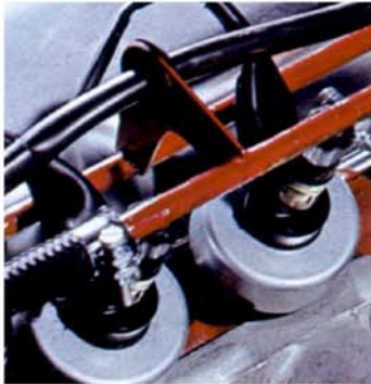
Elektronisch gesteuerte Kraftstoffeinspritzung.
