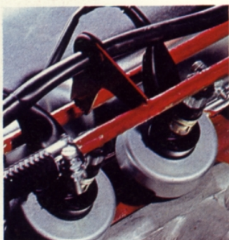
Elektroniskt styrt insprutningssystem.
