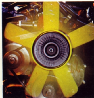
Ny fläkt med slirkoppling som gör att fläktens hastighet aldrig överstiger ca 3000 v/min.
