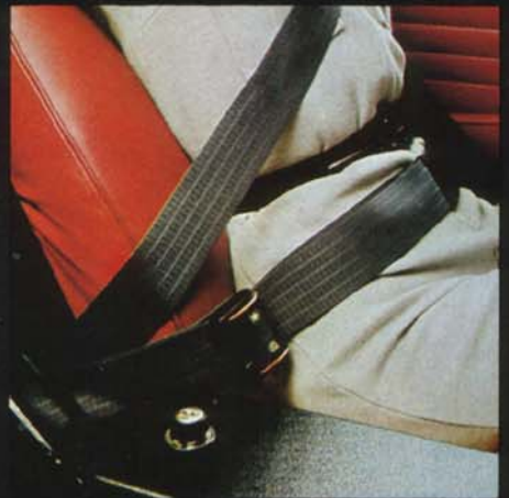
Säkerhetsbälten av trepunktstyp med kraftiga fästen i karossen.
