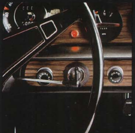
Elektrisk, kopplingsfri överväxel för tystare och mer ekonomisk landsvägskörning. Manövreras med en spak vid ratten.
