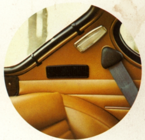
Genomluftningssystemet ger behaglig luftväxling i kupén. Utan drag. Backventilen hindrar avgaser att tränga in bakvägen.
